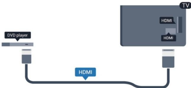
Wenn der DVD-Player über HDMI angeschlossen ist und über EasyLink CEC verfügt, können Sie den Player mit der Fernbedienung des Fernsehers steuern.
