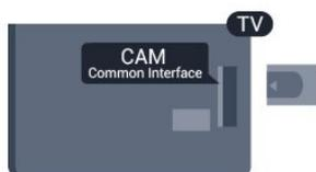
Stecken Sie die CAM-Karte in den Common Interface-Steckplatz des Fernsehers.
