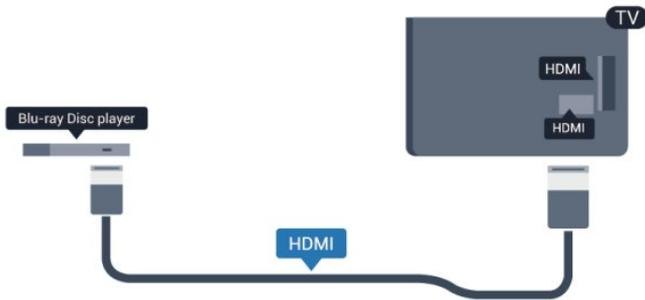
Wenn der Blu-ray Disc-Player über EasyLink HDMI-CEC verfügt, können Sie den Player mit der Fernbedienung des Fernsehers steuern.
